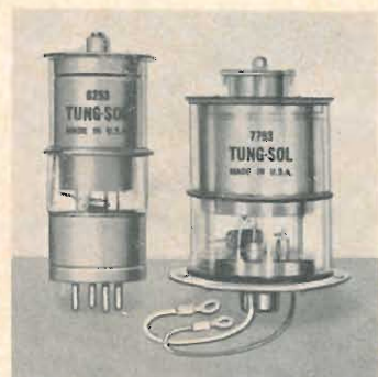
Diodi di vetro all'idrogeno e Thyratrons
